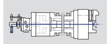
■ TSBF-C e TSBR-C Azionati dal cilindro SIN-S con passaggio centrale per il controllo pneumatico presenza pezzo e/o il lavaggio.
