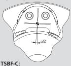
Griffe base flottanti per il serraggio di pezzi grezzi deformabili su 6 punti di contatto.
