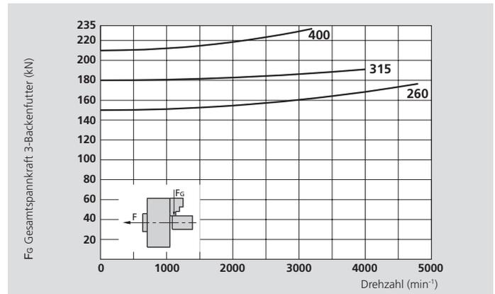
Die Daten in den Diagrammen beziehen sich auf 3-Backenfutter, die nach Bedienungsanleitung frisch gewartet und mit SMW-AUTOBLOK-Fett K67 geschmiert sind. Die statischen und dynamischen Spannkräfte sind mit weichen Standard-Aufsatzbacken gemessen, die nicht radial über den Futterkörper überstehen.
