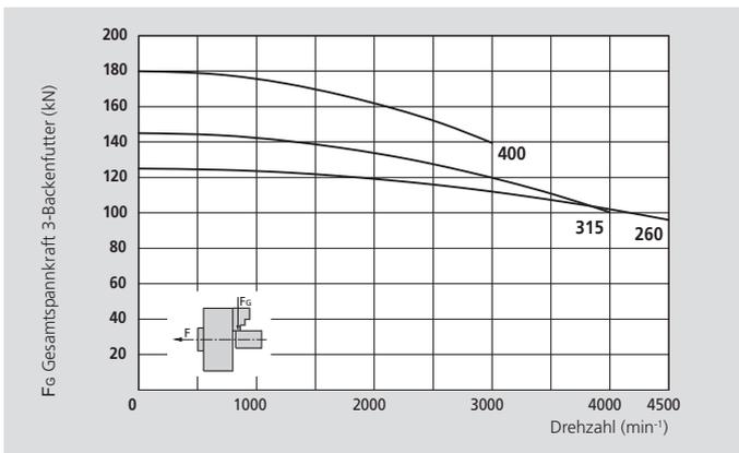
Die Daten des Diagramms beziehen sich auf 3-Backenfutter, die nach Bedienungsanleitung frisch gewartet und mit SMW-AUTOBLOK-Fett K67 geschmiert sind. Die statischen und dynamischen Spannkraften sind mit weichen Standard-Aufsatzbacken gemessen, die nicht radial über den Futterkörper überstehen.
