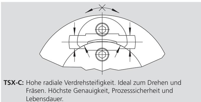
**TSX-C:** Hohe radiale Verdrehsteifigkeit. Ideal zum Drehen und Fräsen. Höchste Genauigkeit, Prozesssicherheit und Lebensdauer.
