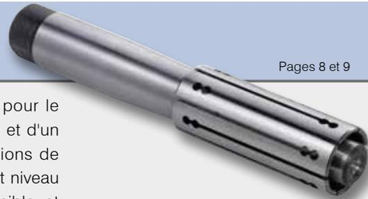
Les mandrins TEP, les plus basiques dans la gamme des mandrins pour le montage des pièces entre pointes, sont constitués d'un arbre conique et d'un manchon expansible. Ils sont utilisés principalement pour les opérations de tournage, de rectification, d'équilibrage et de contrôle. Ils offrent un haut niveau d'expansibilité, 1,5 à 5 mm, en fonction du diamètre du manchon expansible, et peuvent serrer des pièces dont le diamètre est compris dans une plage de 8 à 235 mm.
