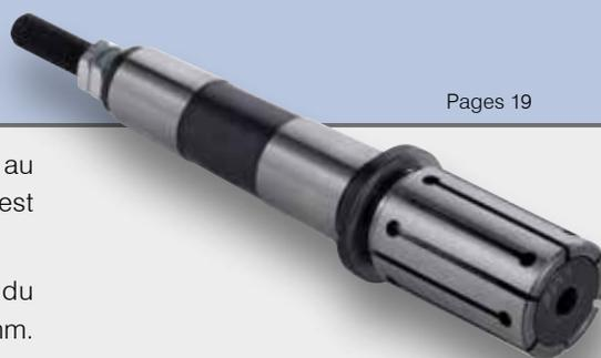
Les mandrins TMCMT sont similaires aux TMCM mais ils serrent la pièce au moyen d'une vis d'entraînement située sur la face arrière du mandrin, qui est connectée à la barre de tirage de la machine.
